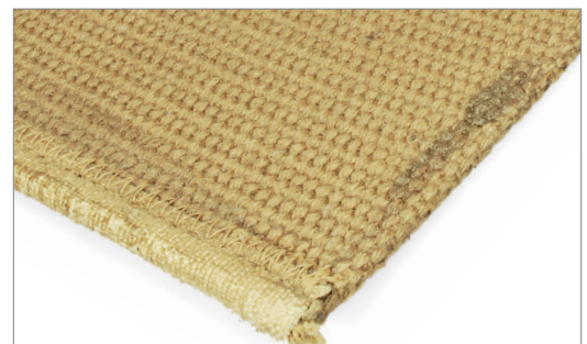
Para-Aramid (Regeneratgarn) mit hitzebeständiger Beschichtung
