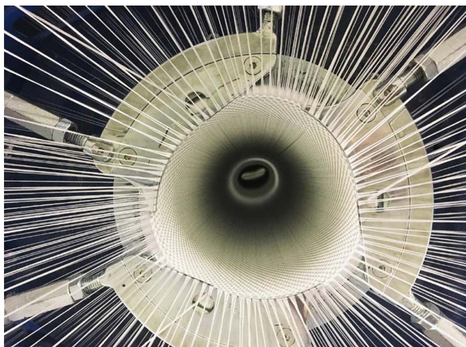
Das Gewebe ist auf der Innenseite mit lebensmittelkonformem Silikon beschichtet.
