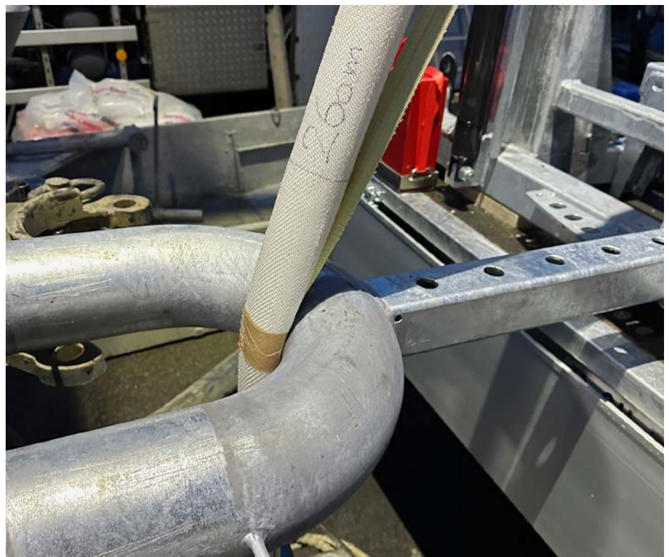
In einer Tiefe von 250 Metern herrscht ein Druck von 25 bar. Deshalb ist der Gewebeschlauch auf eine Extrembedingung von 45 bar ausgelegt.
